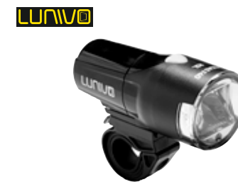
Lunivo VEGAS F40 – RSL Dieses Fahrradlicht ist mit Bewegungs- und Lichtsensoren ausgestattet, die die Lampe automatisch ein- und ausschalten sowie in der Helligkeit regulieren. StVZO zugelassen. Gewicht: 112 g (Lampe ohne Halterung). Max. Leuchtstärke: 40 Lux. Max. Leuchtdauer: 10 h. Leuchtdauer bei max. Leuchtstärke: 2,3 h. 1229013 54,95 €
